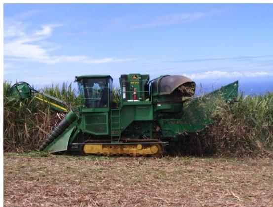
La machine fonctionne comme une coupeuse-tronçonneuse classique. Les cannes tronçonnées sont stockées en continu dans la trémie, qui est vidée dans des caissons ampiroll (ou remorques) en bout de champ. La capacité de la trémie est de l'ordre de 1,1 à 1,5 T selon la canne, ce qui lui donne une autonomie d'environ 100 mètres.
