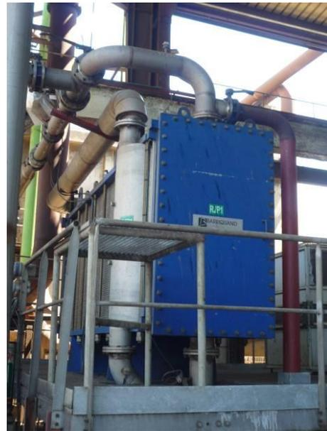
Figure 8. Réchauffeur de jus mélangés à l'aide de condensats à 60°C
