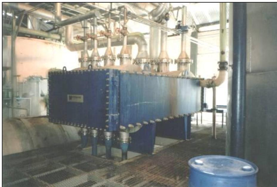
**Figure 10. Réchauffeur multi-circuits à 4 circuits de vapeur indépendants**
