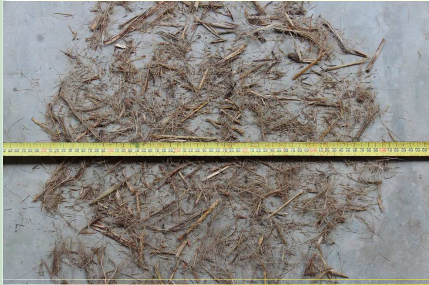
Fibre issue d'un shredder en-ligne
