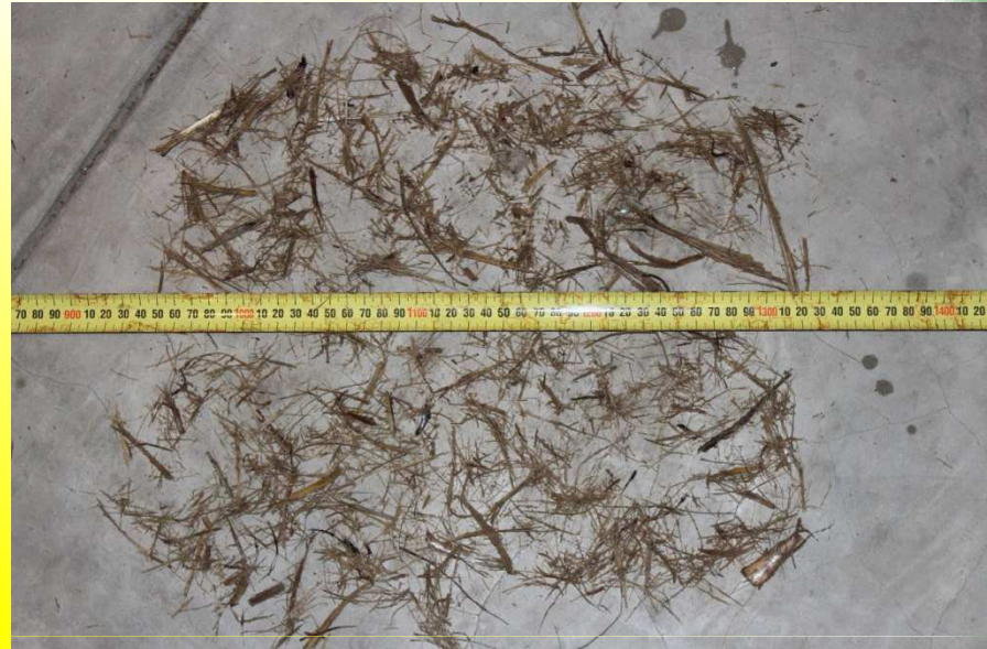
Fibre issue d'un shredder gravitaire
