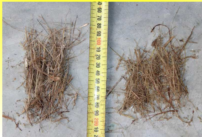
Fibre issue d'un shredder en-ligne
