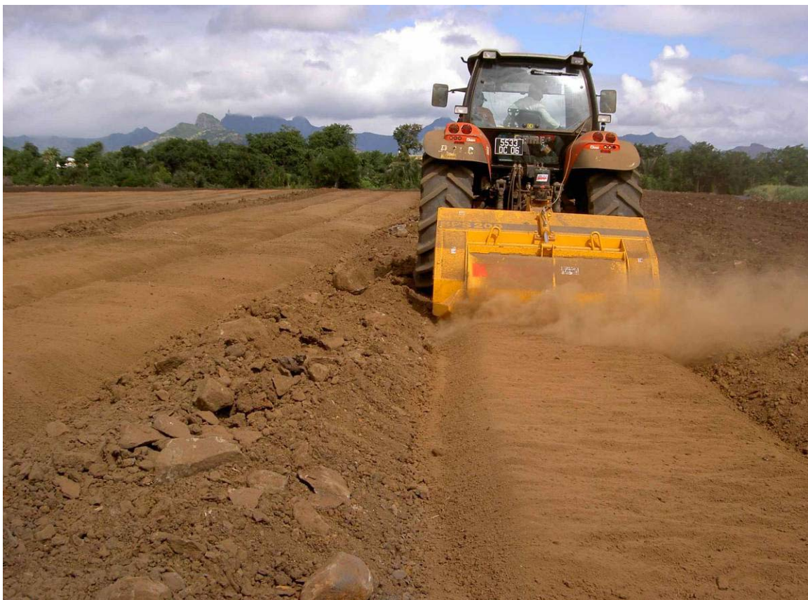
Photo 6 : Broyeur en opération
