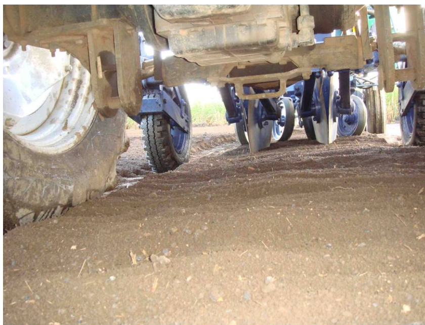
Photo 12 : Ouverture du sol par paire de disques
